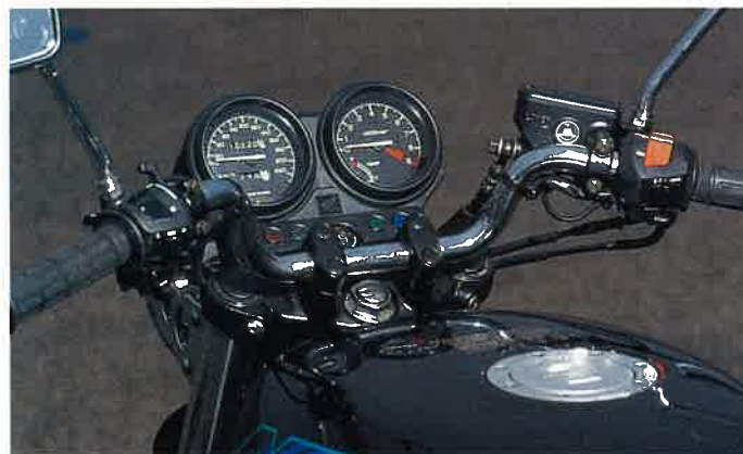
HONDA NTV 650 Alles ohne Handstände, funktional, schnörkellos, gut. Die Honda-Bedienelemente stellen den Neuling vor keine knifflige Lern-Aufgabe. Besonderes Lob verdienen die sicher zu handhabenden Lenkerschalter
