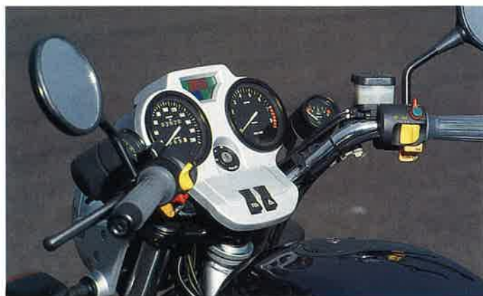
BMW R 80 R Das legendäre Instrumentenbrett mit bestens ablesbaren Uhren und die ergonomisch zu lange ausgetüftelte Dreitasten-Blinkerbetätigung besorgen die Boxer-Kurzweil unterwegs
